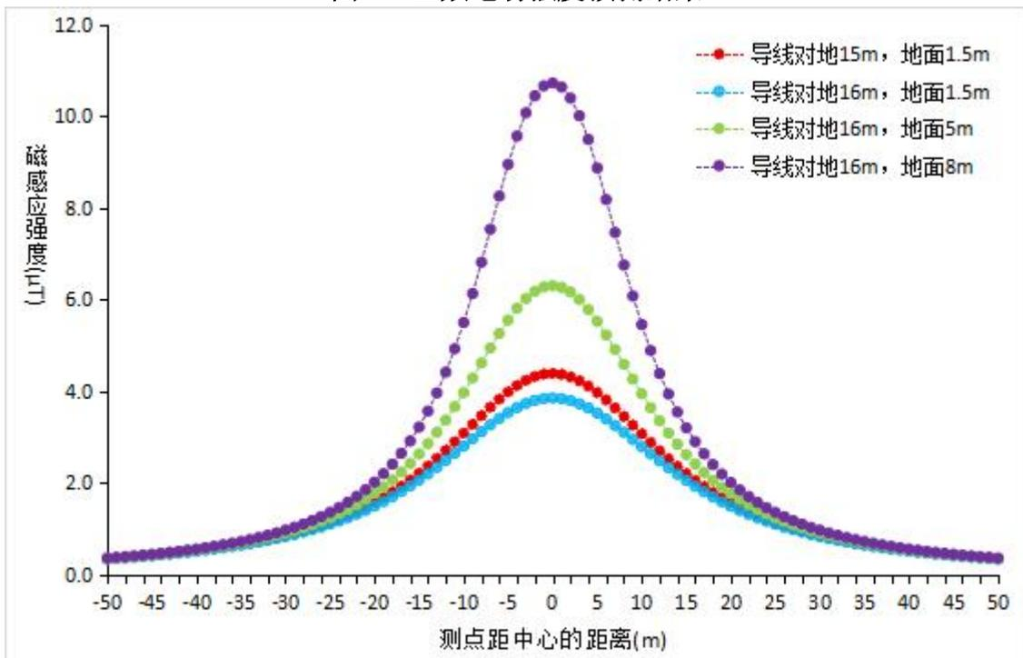
图 7 工频磁感应强度预测结果
