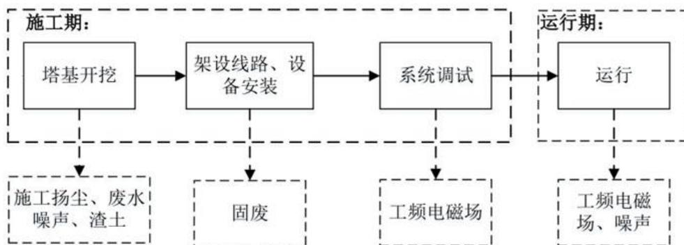
图 2-2 架空输电线路建设流程和产污节点图
