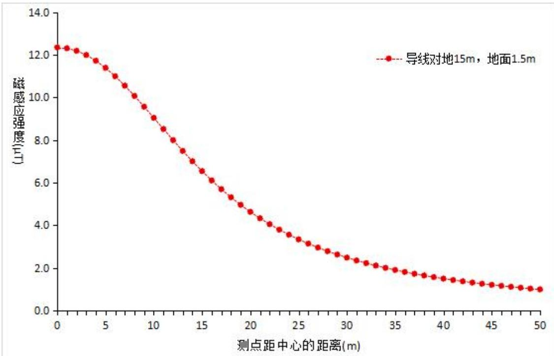
图 5 工频磁感应强度预测结果
